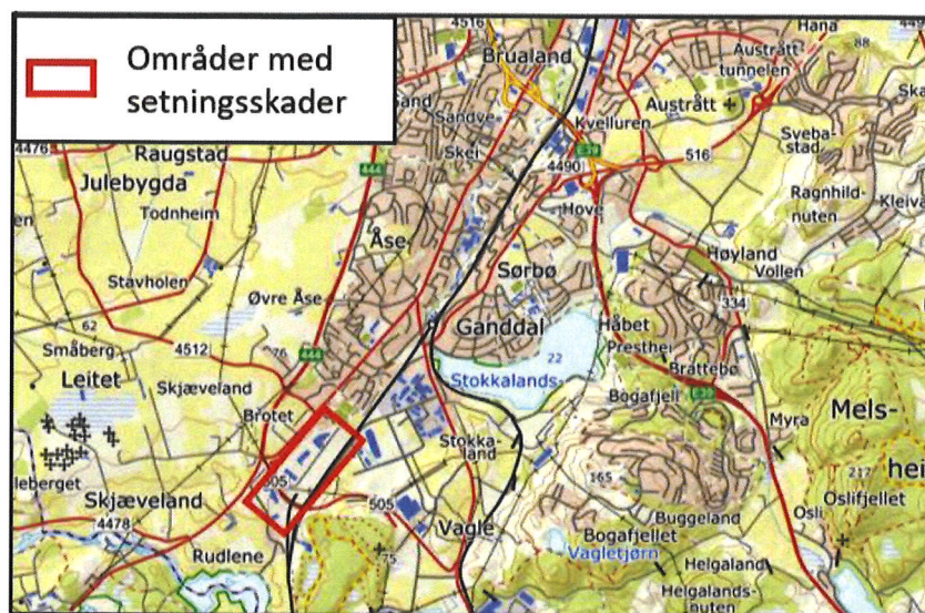
Figur 75 Områder med registrerte setninger på jernbanen (Basert på samtaler med personell i BN).
