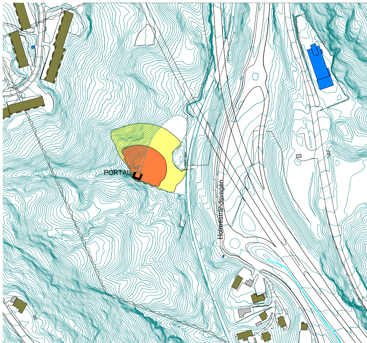
Figur 34: Overordnede beregninger av støy fra anleggsarbeider ved driving av tverrslag Danserud. Oransje sone > 60 dB (grense dag), gul sone 55 dB (grense kveld).
