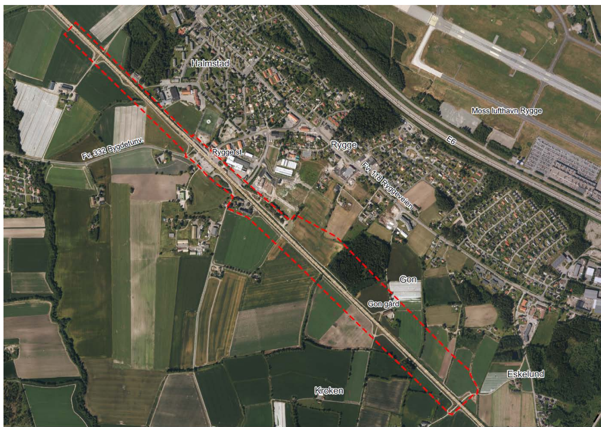
Figur 6 Rød stiplet linje viser avgrensningen av planområdet på Gon. Størrelsen på planområdet er ca. 370 daa. Det er anslått at hensettingsanlegget vil kreve ca. 70 daa. Plassering av anlegget avklares i det videre planarbeidet. Sporutforming er omtalt nærmere i kap. 2.1.
