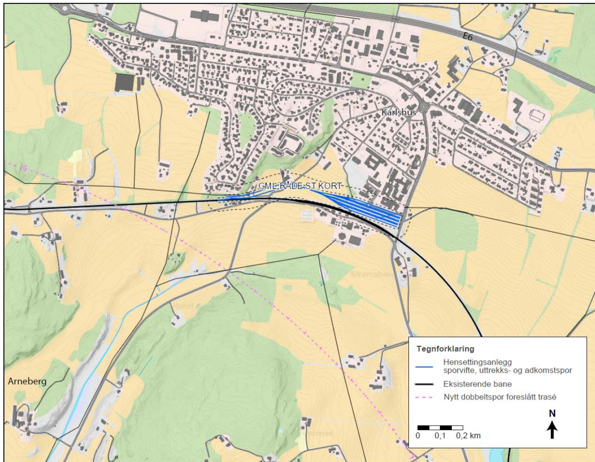
Figur 3-19 Plassering av sporsjablong for Råde stasjon kort løsning. Ventespor er ikke vist på skissen.
