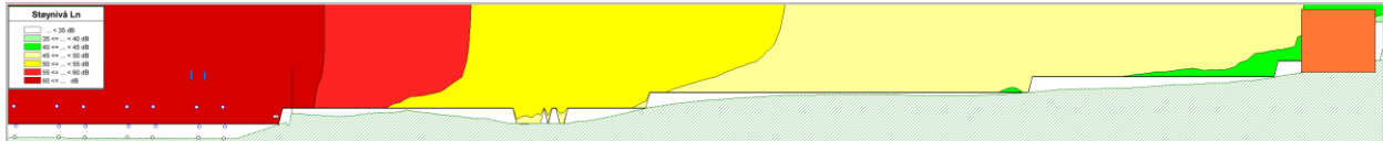
Figur 5.9 Uten skjerm Barkåker nord sørlig. Støysonekart som tverrsnitt, fra hensetting og østover (sett fra syd)
