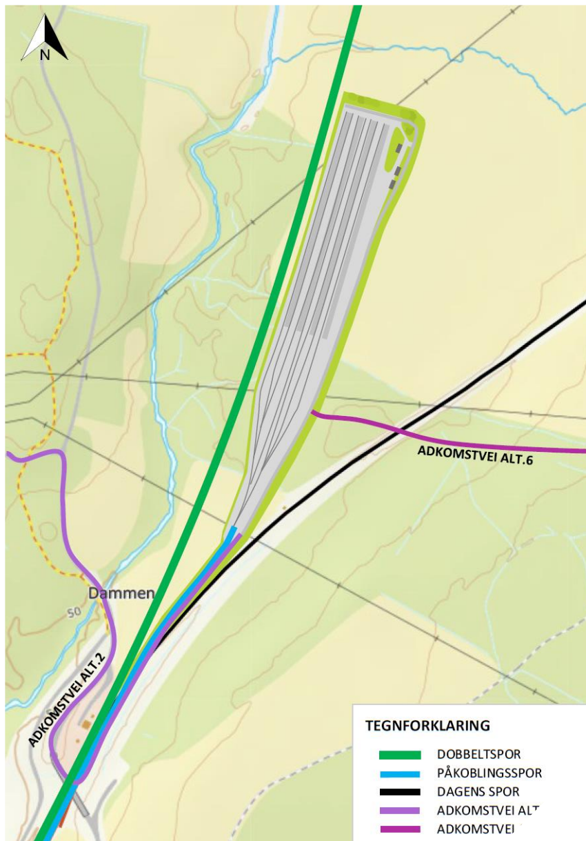
Figur 2.1 Illustrasjon som viser prinsipp for utforming av et optimalisert anlegg ved Skotte. Plassering av bygg, bredde på buffersone, interne veier og mer vil avklares i reguleringsplanen.
