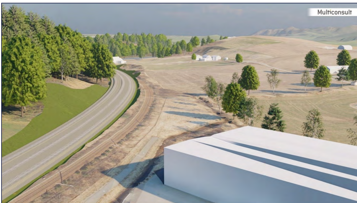
Figur 139: Utbygging medfører inngrep i nedre del av Elisberget til venstre i bildet, vest for eksisterende jernbane. Kontaktledningsmaster og eventuelle støytiltak og støttekonstruksjoner er ikke vist i modellen
