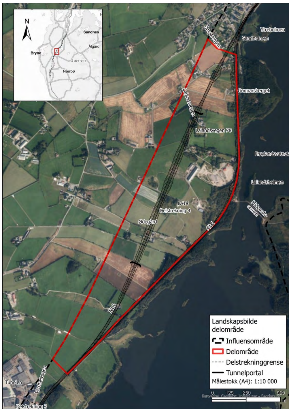
Figur 97: Delområde 14 Tu til Klepp stasjon – jordbrukslandskap. Tunnelen vil gå i løsmasser og er derfor vist med skråningsutslag gjennom tunnelen for å vise omtrent hvor stort inngrepet kan bli
