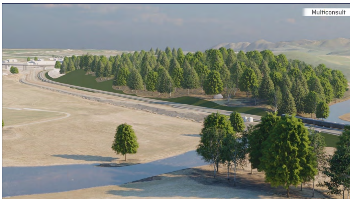
Figur 148: Vagleskogen sett fra sørvest. Alternativ 1 og to går i samme trase langs Vagleskogen og medfører inngrep i terreng og skog. Her er jordskjæringen vist med 1:2. Detaljene avklares videre i reguleringsplanarbeidet. Skråningen slik den er vist her kan revegeteres og over tid gi noe av det samme inntrykket som i dag. Kontaktledningsmaster og eventuelle støytiltak og støttekonstruksjoner er ikke vist i modellen
