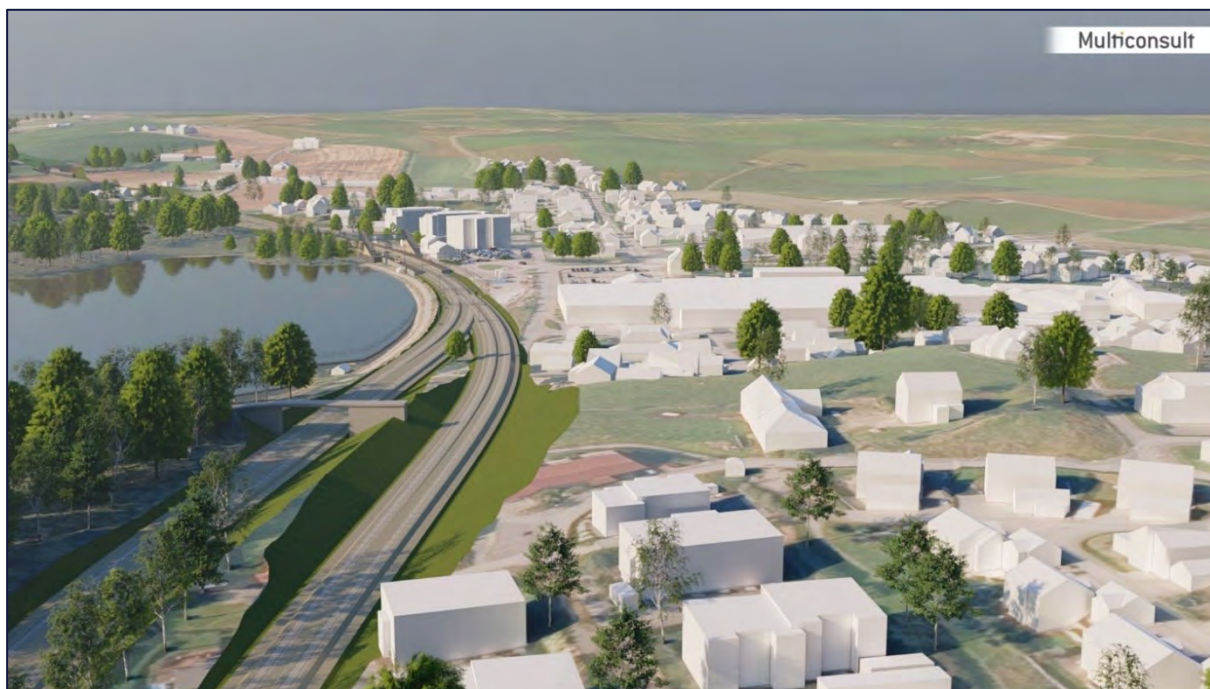
Figur 129: Klepp stasjon sentrum sett fra nord med alternativ 1 og 2. Alternativ 1 nærmest vannet følger eksisterende trase, mens alternativ 2 berører områder utenfor eksisterende baneområde og medfører stenging av en veg lengst nord i sentrum. Kontaktledningsmaster utenfor stasjonsområdene og eventuelle støytiltak og støttekonstruksjoner er ikke vist i modellen
