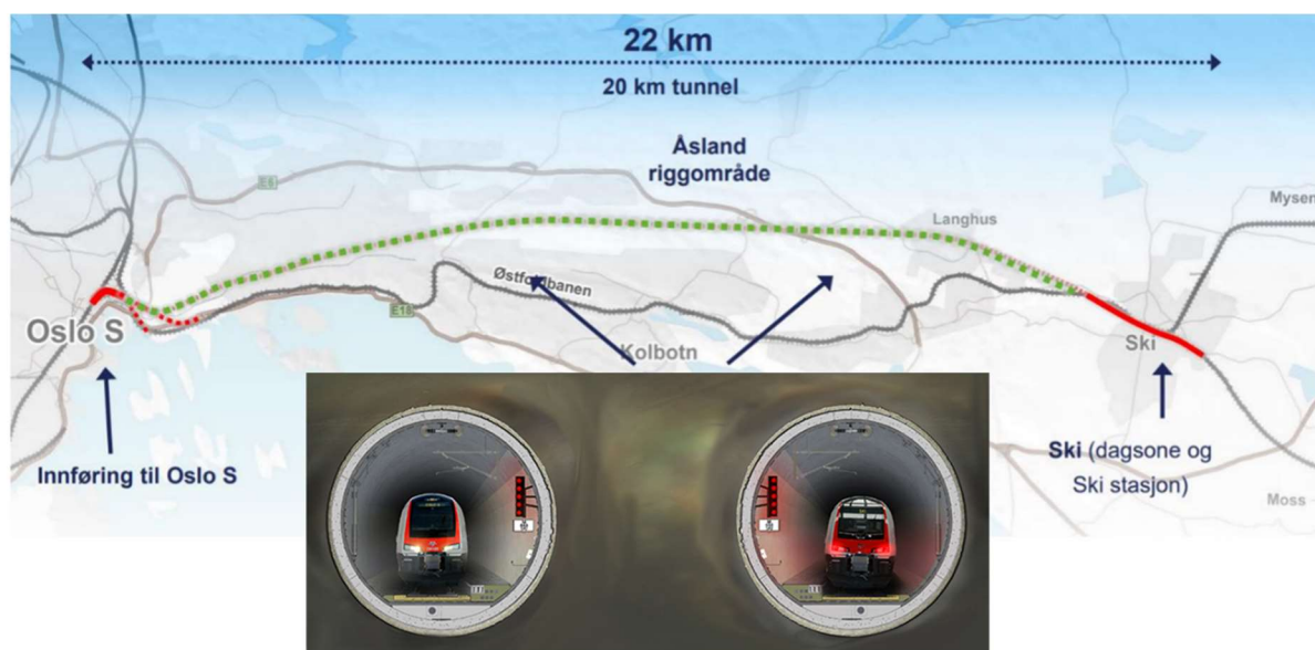
Figur 1 Oversikt over Follobanen og tversnitt av Blix-tunnelen.
