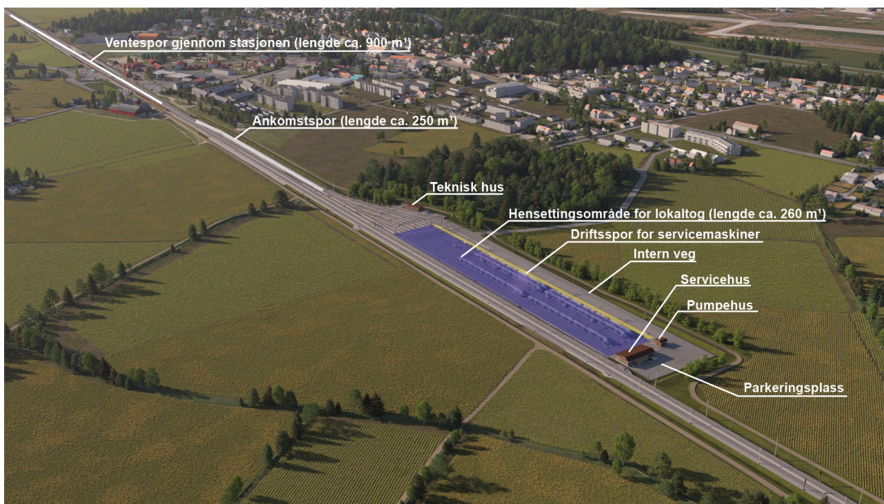
Figur 7 Oversiktsbilde som viser sentrale funksjoner på hensettingsanlegget. 1) lengder er oppgitt som tilgjengelig sporelengde for tog.
