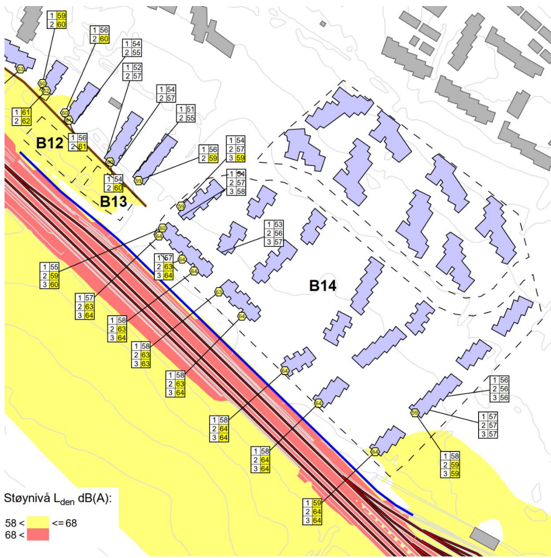
Figur 18. Støy ( L_{den} ) fra Østfoldbanen i prognosesituasjonen 2039 ved regulert ikke-utbygget boligområde sør for Rygge stasjon. Støysonekart er beregnet i høyde 1,5 m over terreng. Fasadenivåer med overskridelser av nedre grenseverdi for gul sone er vist i gule sirkler på den aktuelle fasade. Med eksempel på bygninger. Skjernet.
