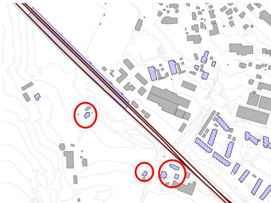
Figur 20. Bygninger med støyfølsomt bruksformål med en økning av vibrasjonshastigheter og strukturlydnivåer i fremtidig situasjon, samtidig som det forventes nivåer over grenseverdiene fra nye jernbanespor.
