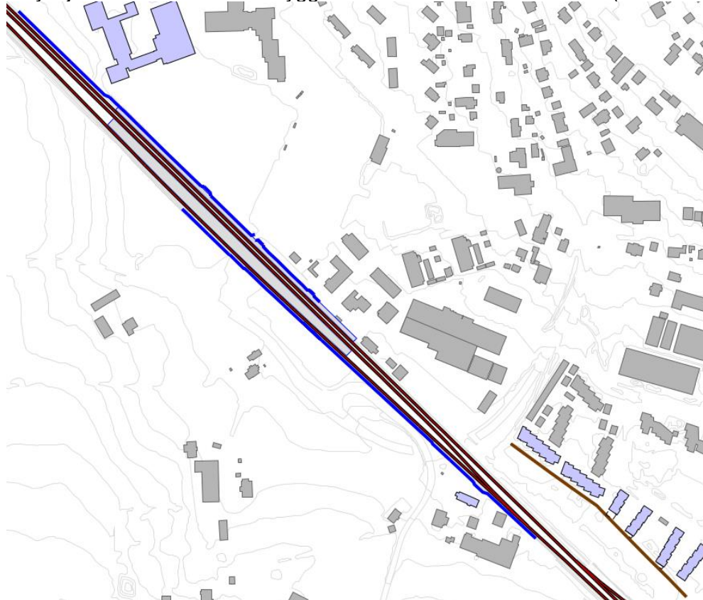
Figur 24. Illustrasjon av langsgående skjermer ved Rygge stasjon. Skjermhøyde 3 m over SOK for nye støyskjermer (markert i blått).
