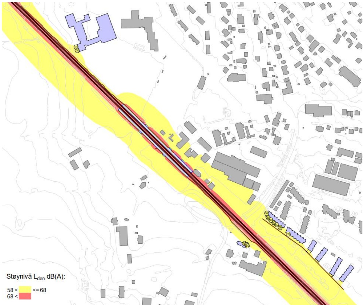
Figur 5. Støy ( L_{den} ) fra Østfoldbanen ved Rygge stasjon for nåværende situasjon 2020. Støysonekart er beregnet i høyde 4 m over terreng. Fasadenivåer med overskridelser av nedre grenseverdi for gul sone er vist i gule sirkler på den aktuelle fasade.
