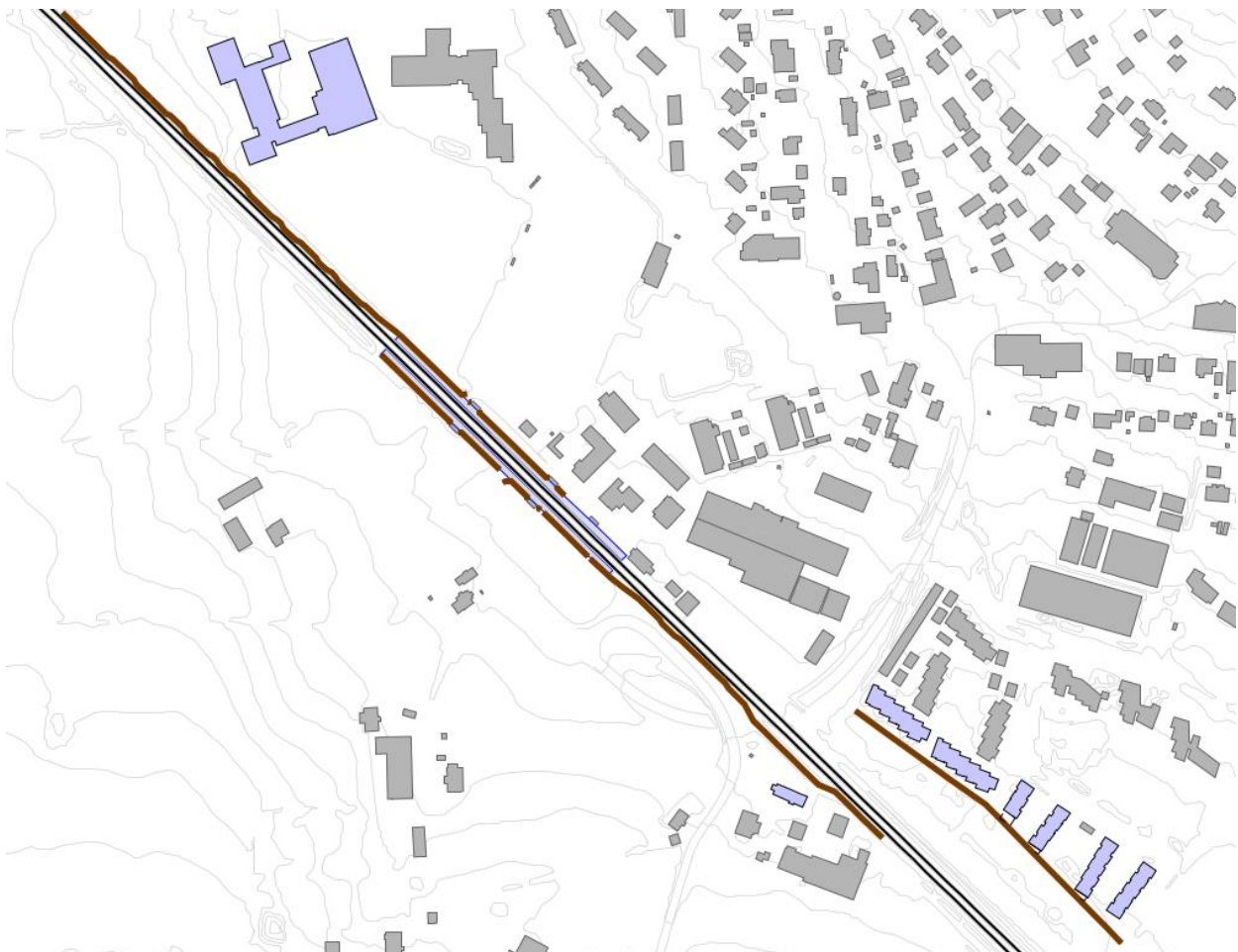
Figur 4. Eksisterende støyskjermer ved Rygge stasjon.
