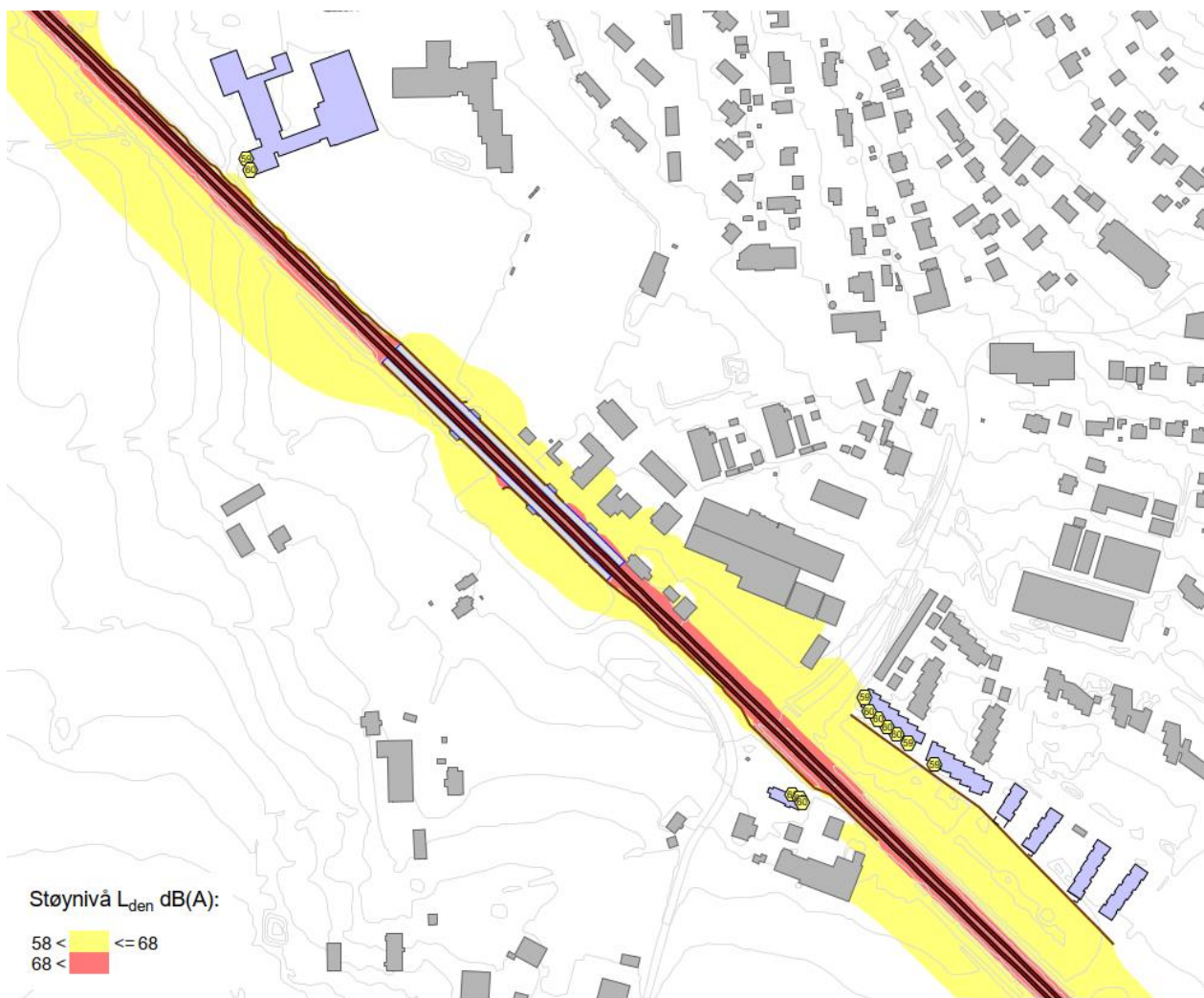
Figur 6. Støy ( L_{den} ) fra Østfoldbanen ved Rygge stasjon for nåværende situasjon 2020. Støysonekart er beregnet i høyde 1,5 m over terreng. Fasadenivåer med overskridelser av nedre grenseverdi for gul sone er vist i gule sirkler på den aktuelle fasade.
