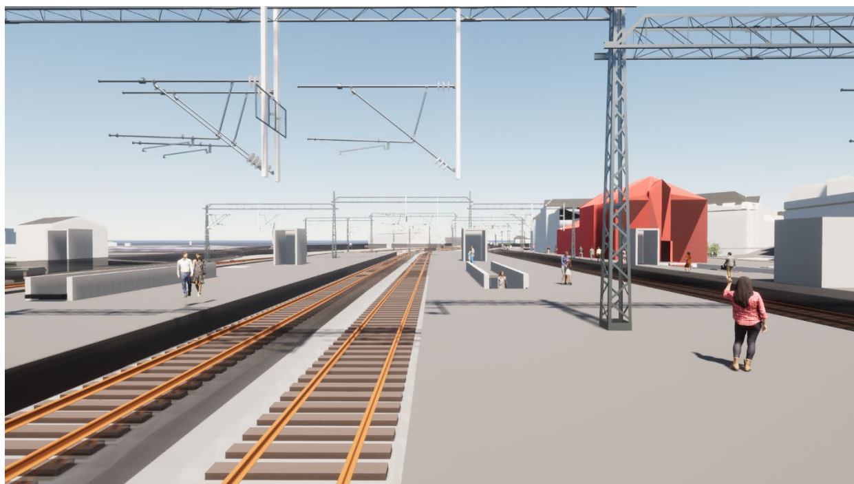
Figur 34 Illustrasjon av størrelse på midtplattform. Trapper og heiser er illustrert, men utforming av disse er ikke bestemt. Plattformtak og møblering av plattformer er ikke vist, og må prosjekteres i neste fase. Restaurantbygget i rødt til høyre i bildet.
