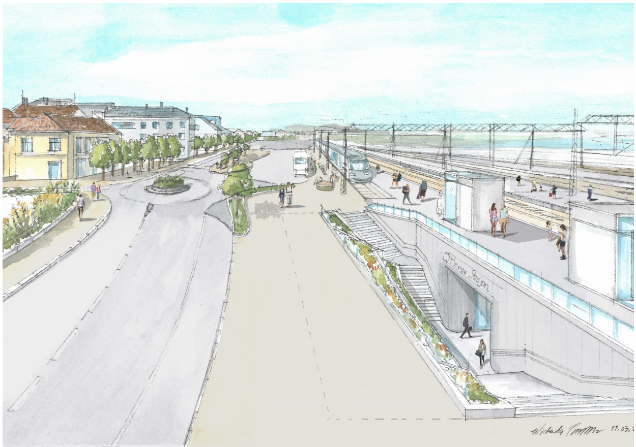
Figur 45 Busstasjonen deler plattform med Rørstoget, og ligger rett ved undergangen med forbindelse til de andre plattformene og de fremtidige byutviklingsarealene på Mjøssiden
