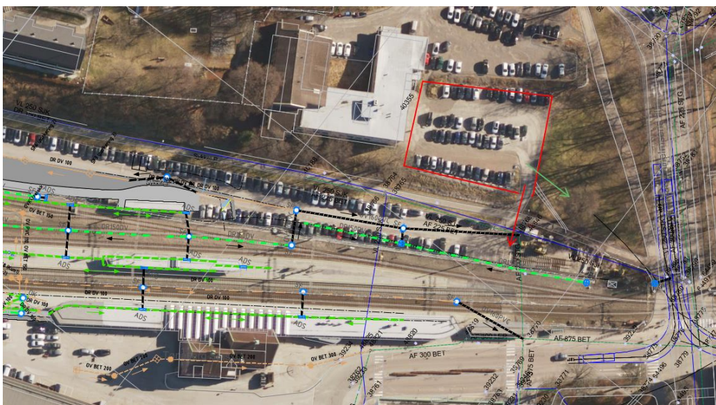
Figur 3.9 Overvann fra området markert med rød boks har avrenning som vist med rød pil.
