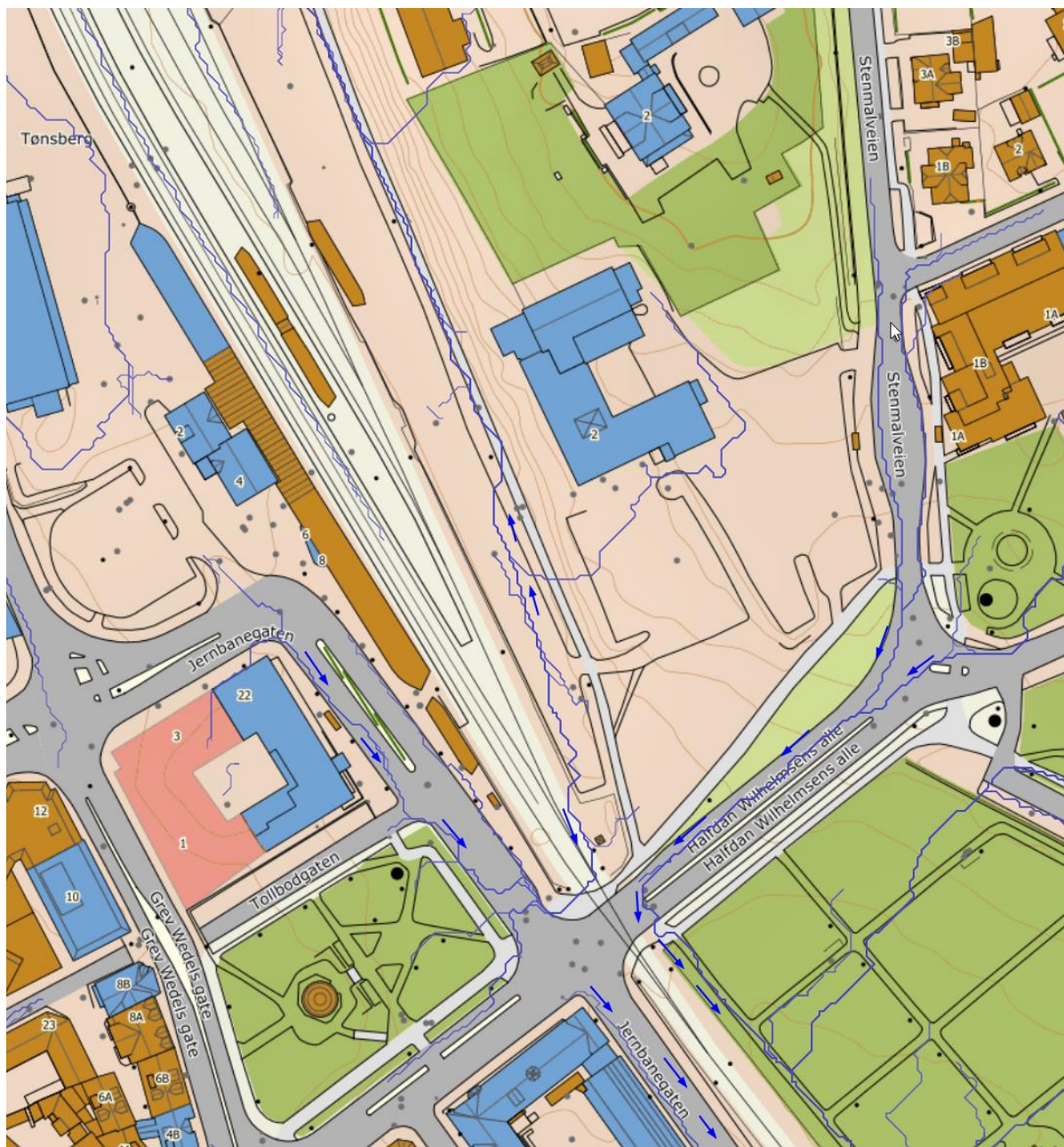
Figur 6.1 Eksisterende flomveier søndre del av Tønsberg stasjon
