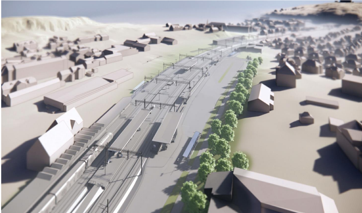
Figur 4-5: Stasjonsområdet sett mot nordvest, østre og midtre plattform med plattformtak. Helt til venstre vises areal for sykkelparkering under tak.
