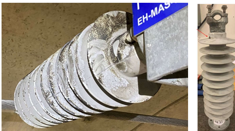
Figur 12 Isolator med hvitt og svart stoff på kortslutningsstedet (og fingermerker) til venstre. Isolator slik den kom frem til laboratoriet til høyre. (Foto: til høyre Bane NOR og til venstre SINTEF Energi AS)
