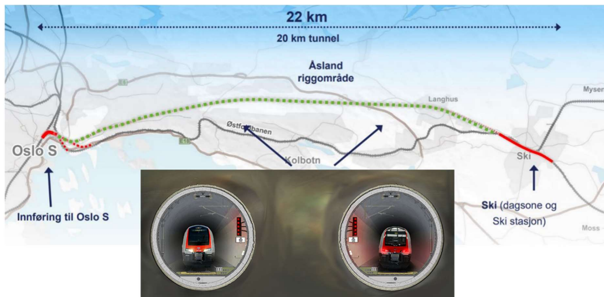
Figur 1 Oversikt over Follobanen og tversnitt av Blix-tunnelen.
