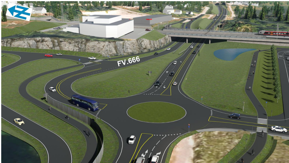
Figur 4-7: Ny permanent rv.19 med ny rundkjøring ved Viulsrød, sett mot øst. Mulig trasé for midlertidig vei er på sørsiden av ny vei
