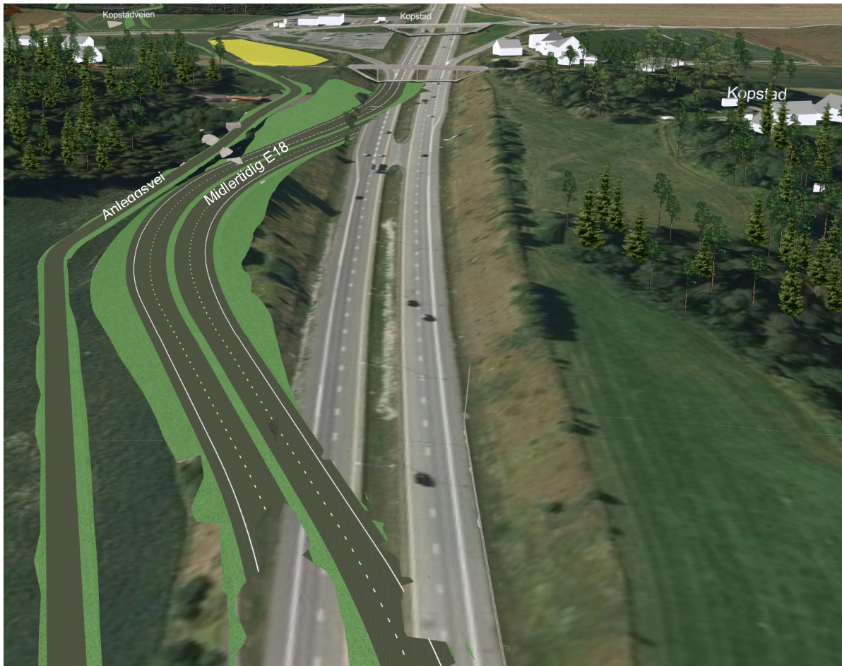
Figur 4-3: Midlertidig trasé for E18, sett mot sør.
