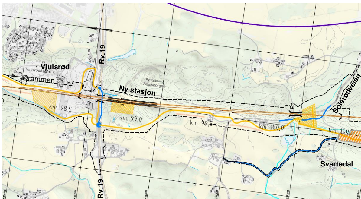
Figur 3-4: Anleggsadkomst for arbeider på Viulsrød og Solerødveien
