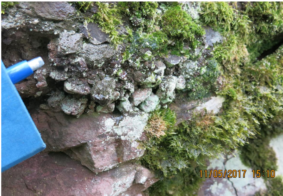
Figur 6-3: Svært løst og åpent konglomerat langs grensen mellom latittlava og rombeporfyr ca. 200 m vest for km. 92,950.
