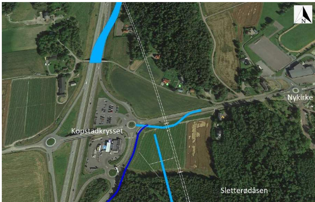
Figur 4-7: Jernbanelinje skal gå i betongkulvert under jordbruksareal øst for Kopstadkrysset. Blå streker viser nye permanente (mørk blå) og midlertidige (lys blå) veier.
