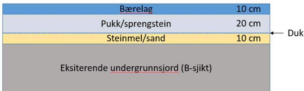
Figur 7-1: Forslag til oppbygging av anleggsvei
