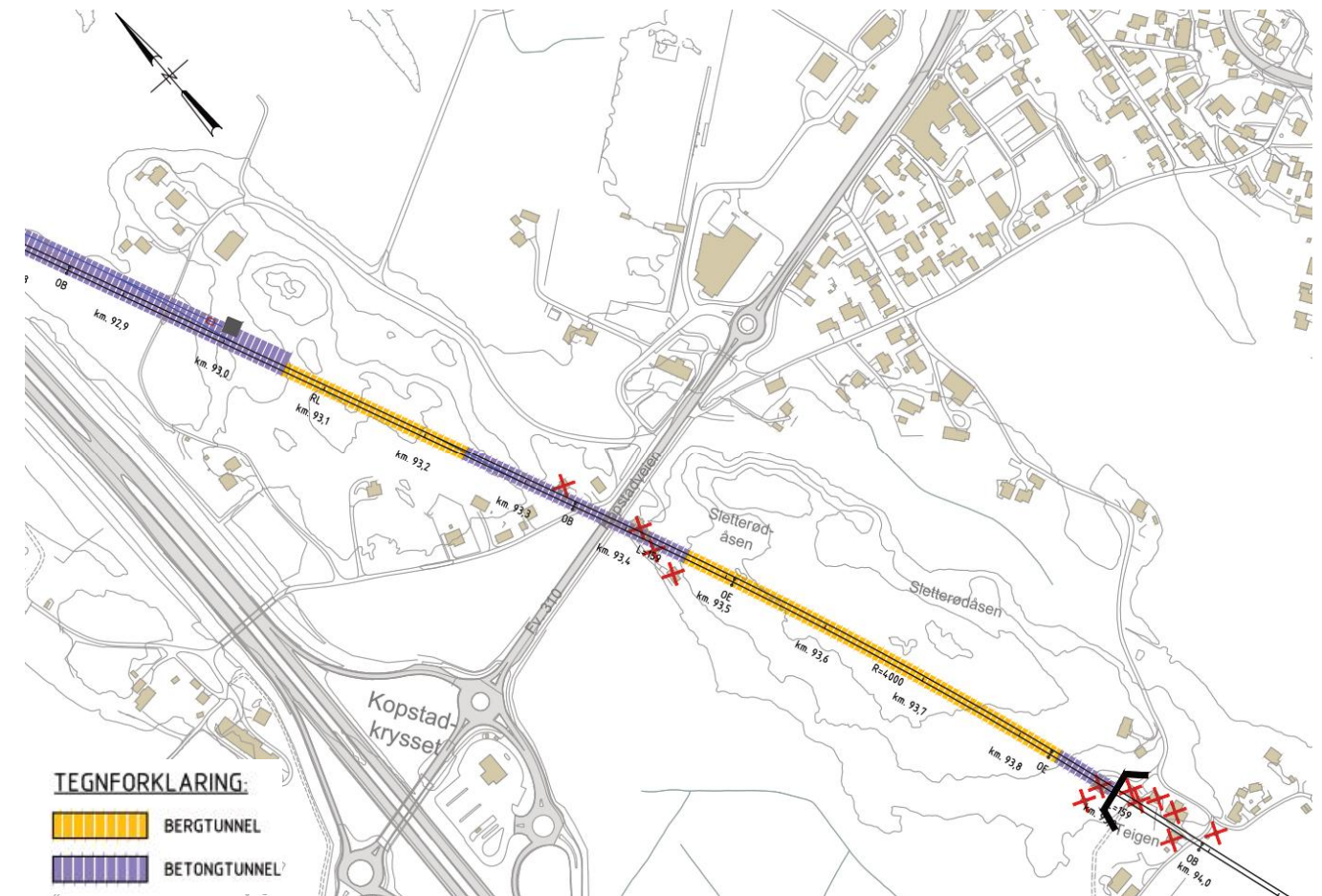
Figur 3-5: Oversiktstegning og lengdeprofil for alternativ 3-4 ved Kopstadveien/Sletterødåsen
