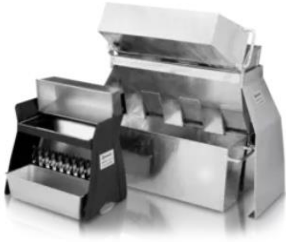
Figur 6. Eksempel på prøvesplittere for å ta ut representativt materiale.
