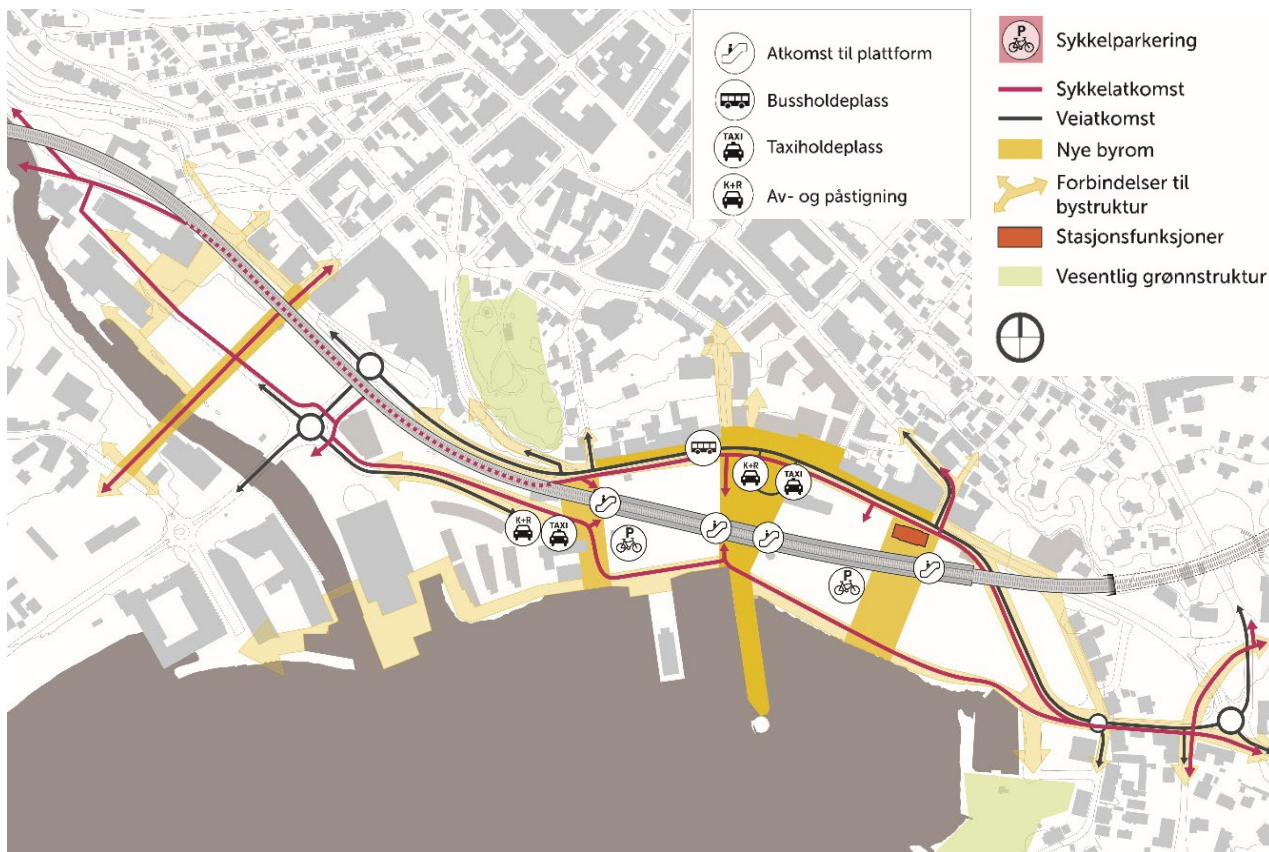
Figur 5-21 Knutepunkttdiagram for stasjonsalternativ Indre havn høy løsning. Diagrammet viser nytt spor og stasjon, funksjoner tilknyttet stasjonen og ferdselslinjer rundt stasjonen. Gangforbindelser framgår ikke i diagrammet.
