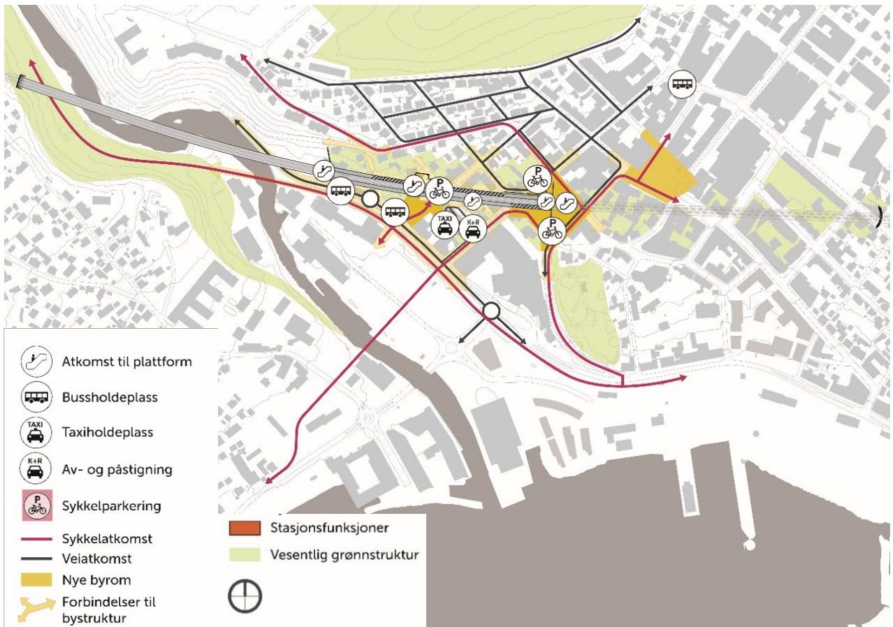
Figur 5-27 Knutepunkttdiagram for stasjonsalternativ Larvik Kongegata høy løsning. Diagrammet viser nytt spor og stasjon, funksjoner tilknyttet stasjonen og ferdselslinjer rundt stasjonen. Gangforbindelser framgår ikke i diagrammet.
