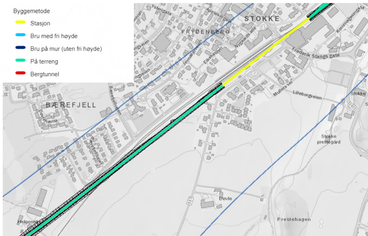
Figur 5-1 Stokke stasjon: Illustrasjon av hvor nytt dobbeltspor går parallelt med dagens spor. Dagens spor vises som enkel grå linje. Blå linjer er ytterkant av utredningskorridor.
