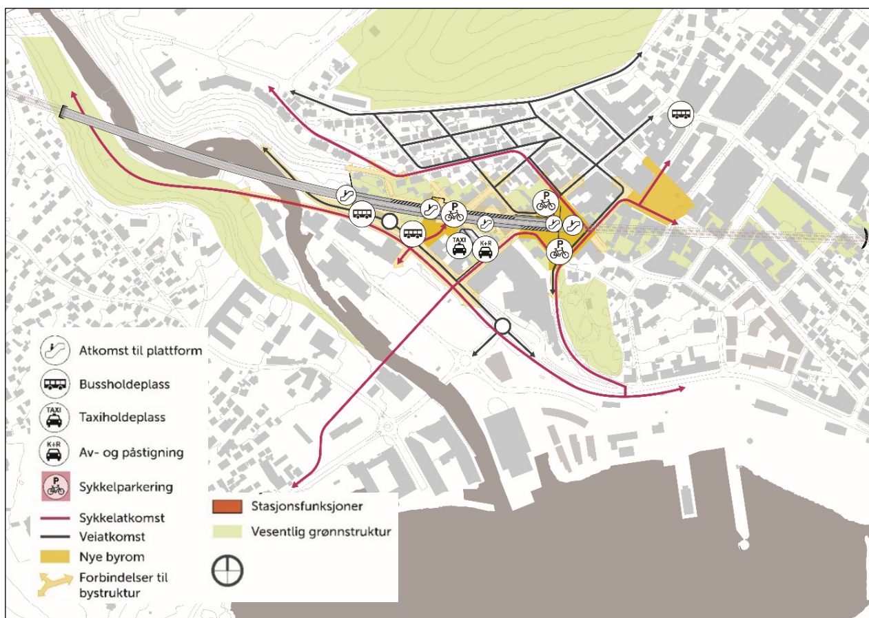
Figur 3-14 Diagram som viser knutepunktet, sentrale funksjoner tilknyttet stasjonen og ferdselslinjer for alle trafikanter til stasjon i Kongegata og gjelder både høy og lav løsning. Illustrasjonen er foreløpig og kan bli endret i neste planfase.
