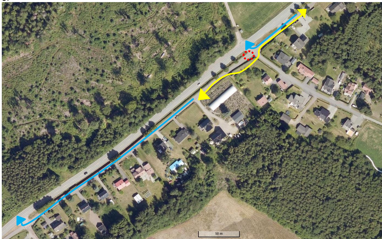
Figur 5: Gul markering/pil viser mulig fremkommelighet for mange trafikanter på gang- og sykkelvei langs Hortensveien i anleggsfasen. Blå markering/pil viser mulig fremkommelighet for berørte eiendommer i anleggsfasen.
