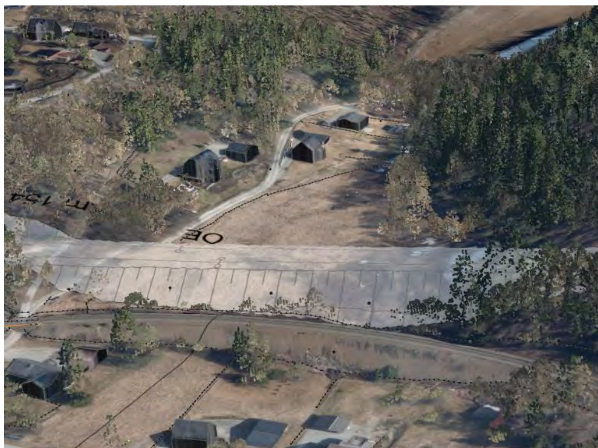
Figur 6-57: Ekredalen sett fra sørvest. Banen ligger på fylling i alle alternativer (bildet viser alternativ B).
