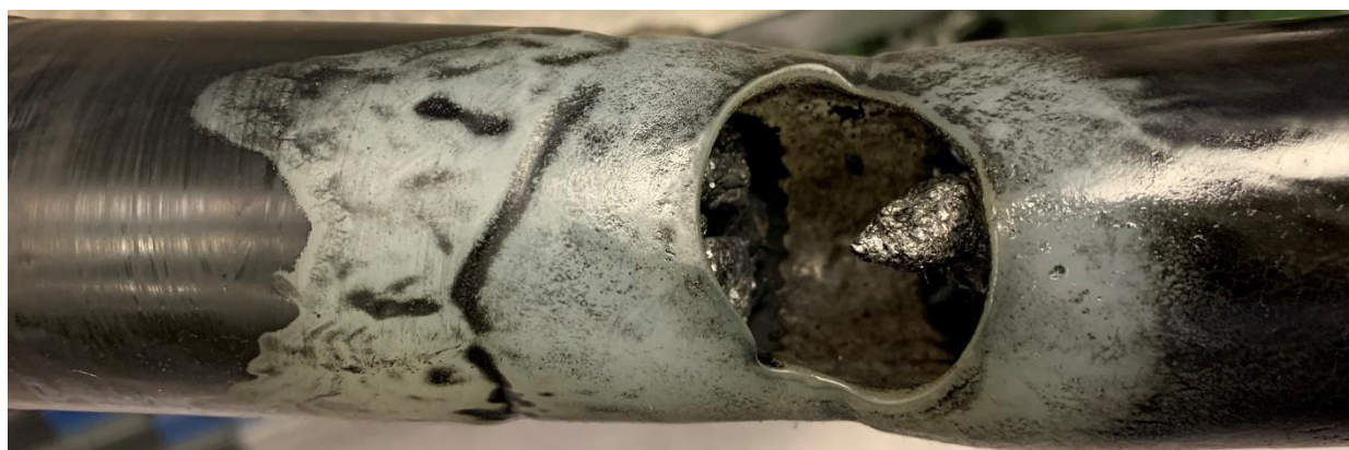
Figur 5: Bildet er tatt av SINTEF Energi AS og viser ødelagt kabelisolasjon
