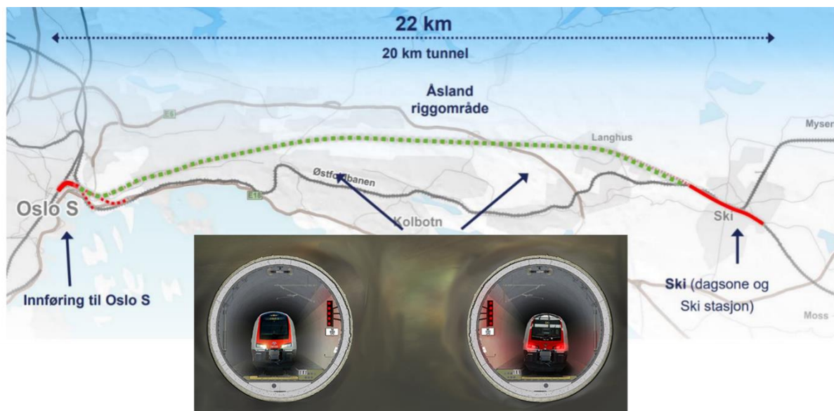
Figur 1 Oversikt over Follobanen og tversnitt av Blix-tunnelen.
