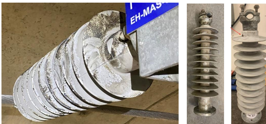
Figur 13 Isolator med hvitt og sort stoff på kortslutningsstedet (og fingermerker) til venstre. I midten slik den kom inn fra tunnelen. Isolator slik den kom frem til laboratoriet til høyre. (Foto: til høyre og midten Bane NOR og til venstre SINTEF Energi AS)
