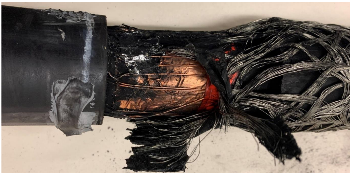
Figur 8 Den «friskeste» enden av en av de brente kabelskjøtene. (Foto: SINTEF Energi AS)
