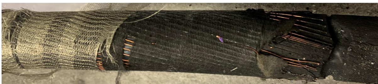
Figur 7 Ytterkappe på endeavslutning er tatt av og bildet viser til at alle kobbertrådene er brent av. Det sorte svelebandet er helt og hindret direkte elektrisk kontakt mellom skjermene. (Foto: SINTEF Energi AS)
