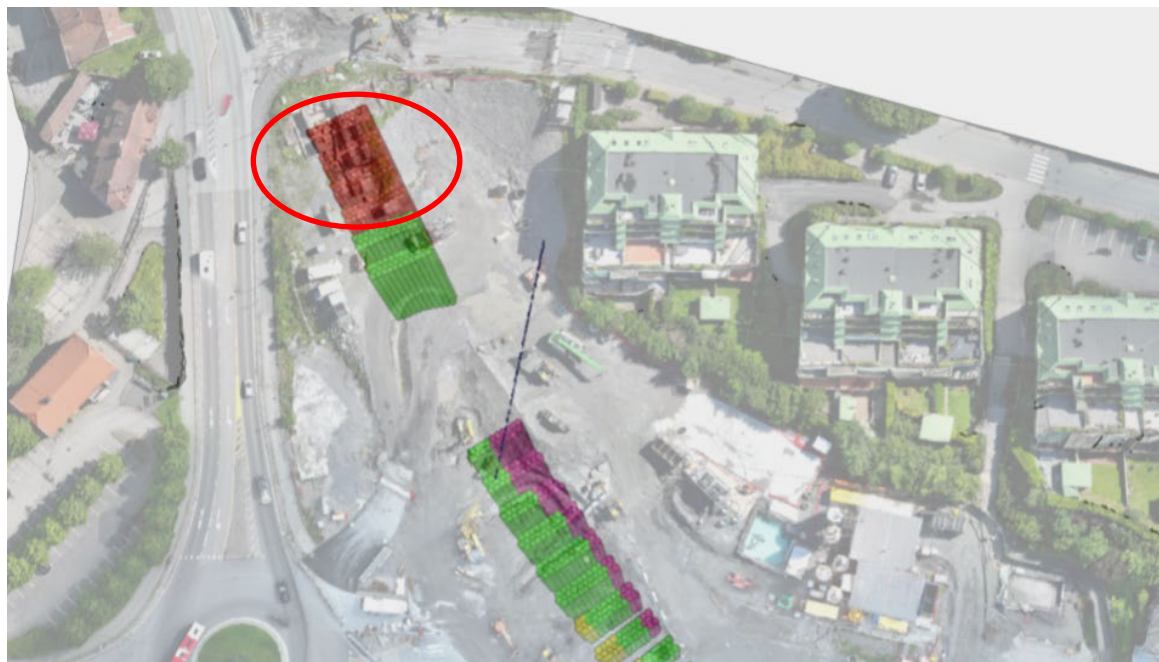
Figur 1. Oversiktsbilde av Kransen nord, som illustrerer arbeidet som utføres med jetpeling. De forskjellige fargene viser fasene, der de begynner med de grønne rekkene, deretter følger de blå, rosa, gule og til slutt de lilla rekkene. Dette varselet gjelder for det rosa området (lengst nord).
