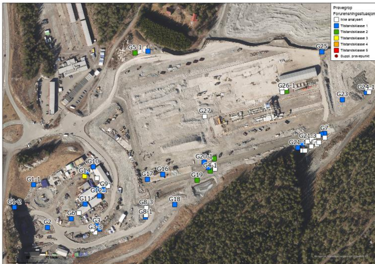
Figur 10. Oversiktskart med prøvepunktene undersøkt av AGJV. Punktene er plassert ved områdene der AGJV mistenkte forurensning. Prøvene er tatt som overflateprøver. Symbolene er fargelagt etter påvist tilstandsklasse, jf. klassifiseringssystemet i Miljødirektoratets veileder for forurenset grunn (6).
