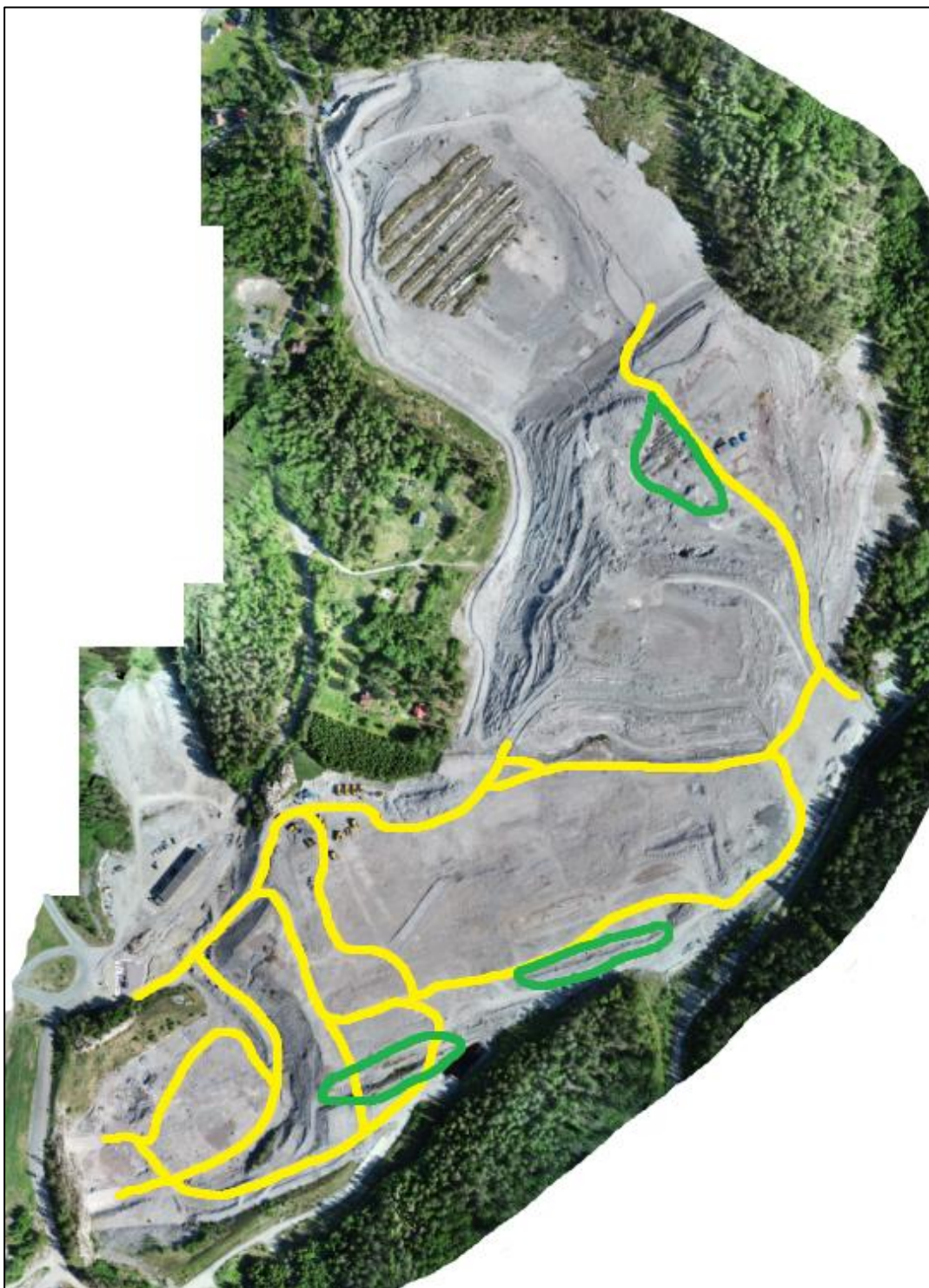
Figur 17. Oversikt over områder med masser som inneholder plastavfall. Gul linje viser anleggsveier hvor slike masser er benyttet. Grønnmarkerte områder viser fyllinger bestående av slike masser. Disse massene skal leveres til godkjent mottak.
